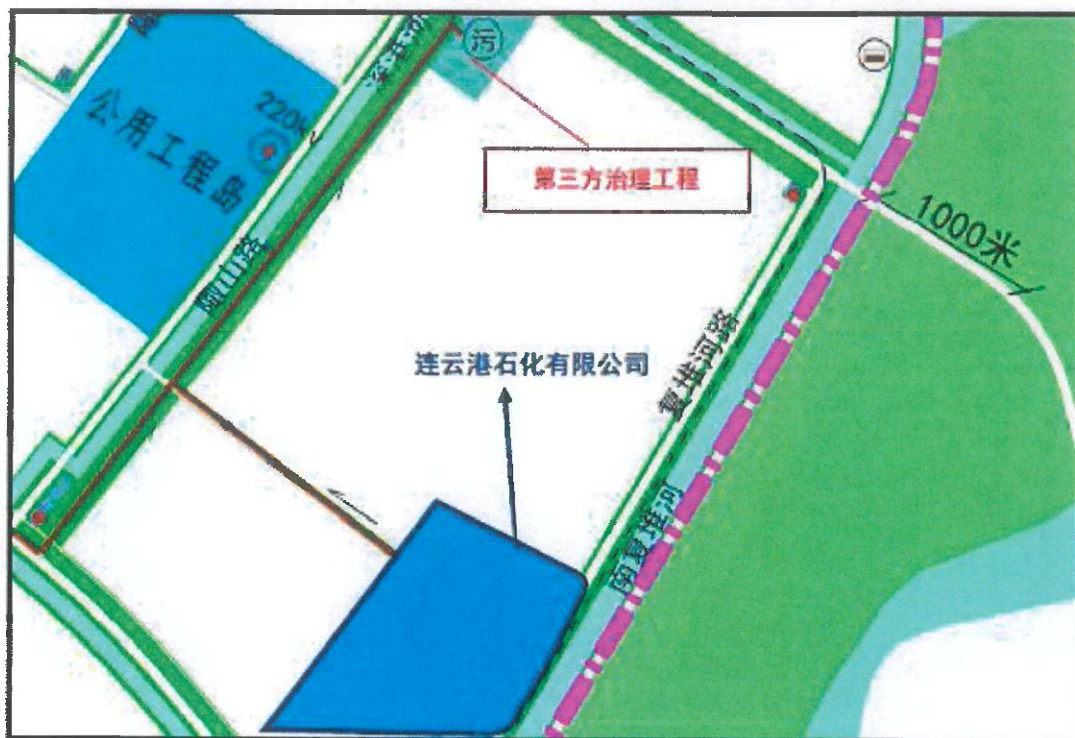
图 3.1.3-2 第三方治理工程收水管网图
